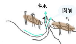
⑥ 堆積土開削による導水
